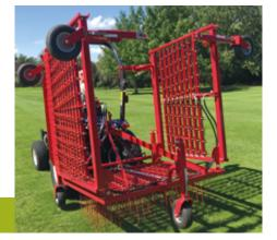
Le **Spin-Rake 450** à repliage hydraulique est idéal pour les grandes surfaces, avec ses dents tournées vers l'intérieur en position de transport.
